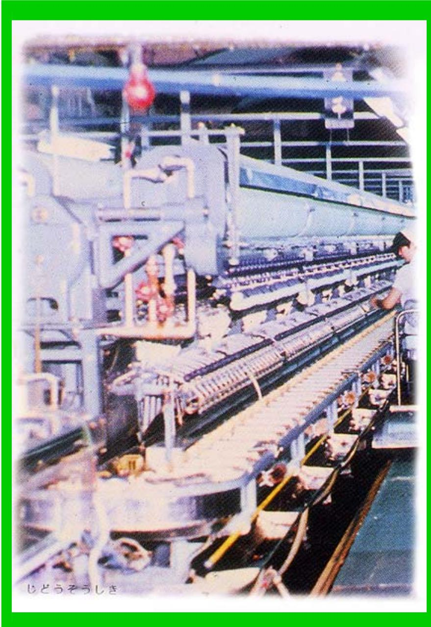
昭和20年以降になると、生糸の太さを自動に感知する装置(織度感知装置)や、まゆが足りなくなるとすべて自動的に補給する装置が設置された自動繰糸機が開発されました。どの生糸を接緒しなければいけないかを機械が感知し、自動的に接緒してくれるようになったのです。能率、品質はすばらしく進歩しました。
