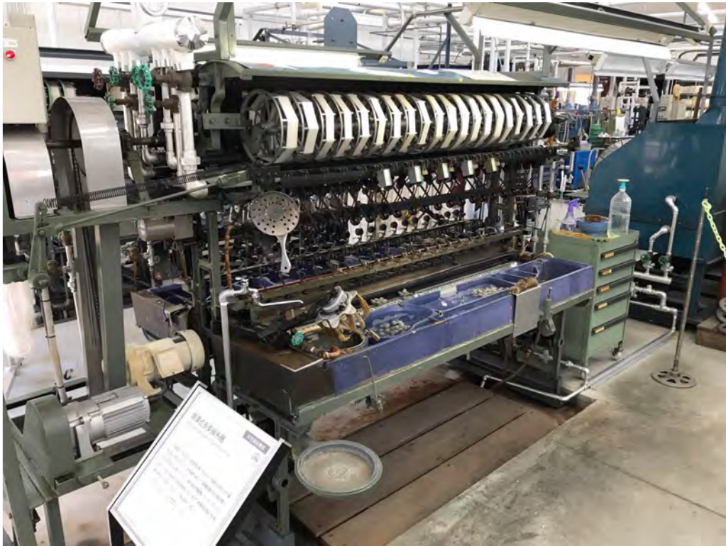
岡谷蚕糸博物館内で動態展示している増沢式多条繰糸機。
